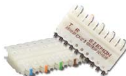
S110C-5..... 5-парный пробивной блок к кроссу, маркировка пар по цветам: синий, оранжевый, зеленый, коричневый, серый
