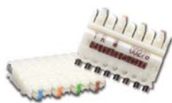
S110C-4..... 4-парный пробивной блок к кроссу, маркировка пар по цветам: синий, оранжевый, зеленый, коричневый
