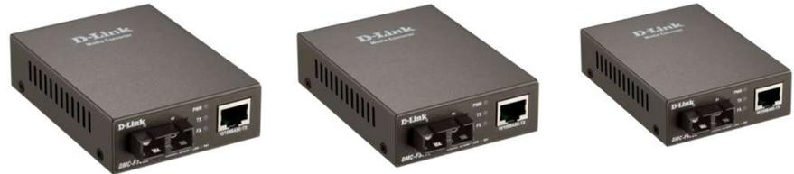
Данный медиаконвертер преобразует сигнал из стандарта 10BASE-T/100BASE-TX Fast Ethernet на витой паре в сигнал стандарта 100BASE-FX Fast Ethernet по одномодовому оптическому кабелю. Устройство оснащено 1 портом RJ-45 для витой пары и 1 оптическим портом с разъемом SC. Конвертер поддерживает функцию LLR (Link Loss Return) для оптического порта.
