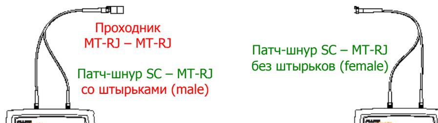
Рассоединив коннекторы MT-RJ со штырьками (male) и без штырьков (female), мы подключаем к первому из них дополнительную перемычку MT-RJ, оба конца которой штырьков не имеют (female). Проверьте получившееся количество проходников в сегменте.
