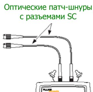
Затем к сегменту добавляются две дуплексных перемычки: одна ST – MT-RJ (female), другая ST – LC. Чтобы упростить картину, вы можете представить, что коннекторы ST – это просто коннекторы SC, подключенные к портам тестера.
