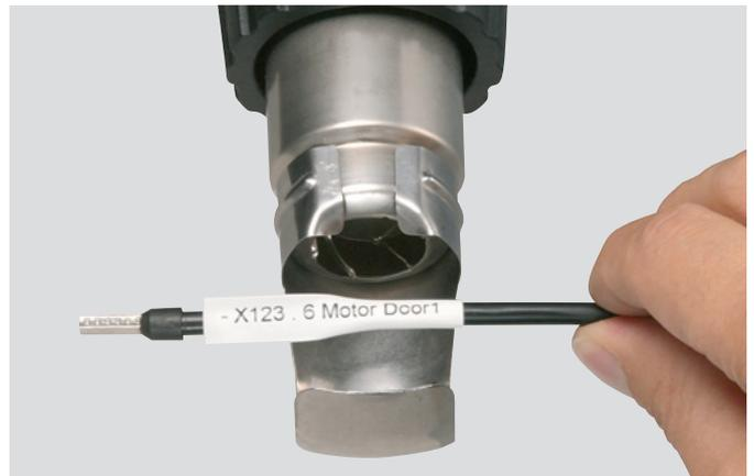
При применении стандартного электрофена обеспечивается коэффициент усадки 2:1 или 3:1.
