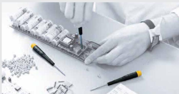
Отвертки Wiha ESD соответствуют международным нормам защиты от электростатического заряда IEC 61340-5-1. Электрическое поверхностное сопротивление составляет  $10^6 - 10^9$  Ом. Благодаря колпачку быстрого кручения с большой поверхностью для захвата работать данным инструментом очень удобно и быстро. Массивный конец рукоятки позволяет осуществлять сильную затяжку и откручивание винтов.
