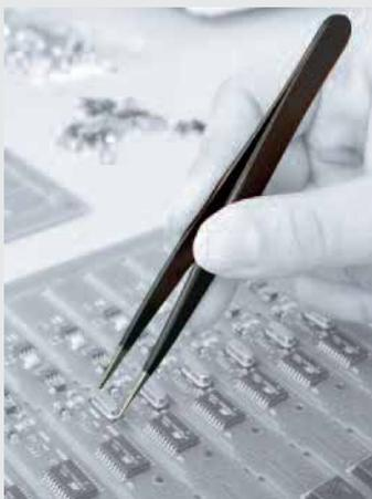
Благодаря большому выбору наконечников точный пинцет Professional ESD без труда справляется даже с самыми щекотливыми задачами, например, при работе с чувствительными полупроводниками.
