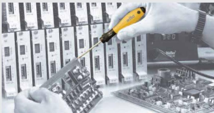
Твердая сердцевина рукоятки изготовлена из ударопрочного полипропилена. Поверхность изготовлена из приятного на ощупь термопластичного эластомера, который обеспечивает удобный и надежный захват без проскальзывания. Покрытие жестко соединено с сердцевиной рукоятки при помощи литья под давлением. Высококачественные жала из хром-ванадий-молибденовой стали полностью закалены и матово хромированы. Оптимальное размещение в головке винта гарантирует наконечник Wiha ChromTop.
