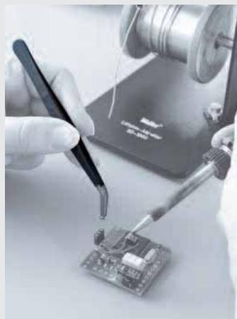
Пинцеты являются важными инструментами для каждого специалиста по электронике, обеспечивающими надежное выполнение необходимых работ часто в небольших и тесных структурах печатных плат.
