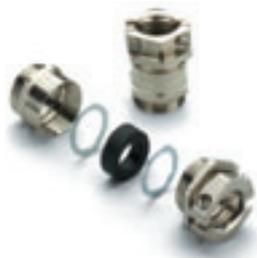
Латунный кабельный ввод с наружной центральной разгрузкой натяжения кабеля с помощью зажимного кулачка. Используемая уплотнительная вставка содержит несколько извлекаемых или отделяемых слоев.
