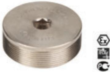
Заглушка с внутренним шестигранником. Применяется для закрытия неиспользуемых резьбовых отверстий. Имеется сертификат по виду защиты: взрывонепроницаемая оболочка.
