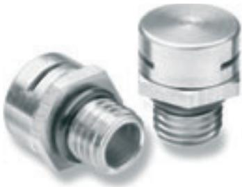
Компенсатор перепада давления рекомендуется для обеспечения оптимальной вентиляции корпуса а также для предотвращения образования конденсата При этом сохраняется высокая степень защиты Мембрана обладает водо и маслоотталкивающими свойствами
