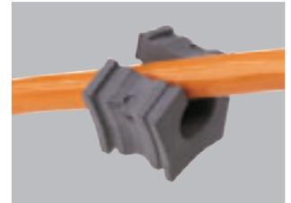
Вдавите уплотнительную ячейку с кабелем в открытый кабельный ввод. В плоская сторона уплотнительных ячеек должна быть направлена вверх.
