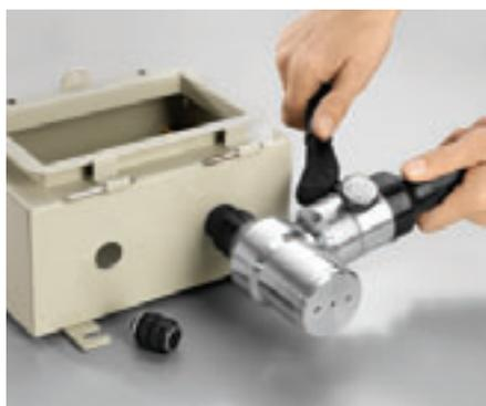
С помощью гидравлического пробойника для отверстий в листовом материале выполняются точные отверстия для кабельных вводов с метрической резьбой и резьбой.
