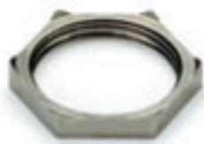
Зубчатые гайки для фиксации латунных кабельных вводов и заглушек специально снабжены зубьями которые обеспечивают контакт гайки с корпусом после затяжки
