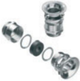
Промышленные латунные кабельные вводы с разгрузкой натяжения кабеля и трубчатым устройством защиты от изгиба пригодны для подключения нестационарно проложенных кабелей и проводов. Используемая уплотнительная вставка содержит несколько извлекаемых или отделяемых слоев.
