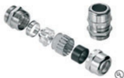
Латунный кабельный ввод для экранированного кабеля обеспечивает защиту от высокочастотных помех затухание до 40 дБ Большая поверхность контакта с экраном кабеля обеспечивается благодаря металлическому каркасу конической формы Очень простая установка кабельного ввода благодаря тому что он не разделяется на отдельные части
