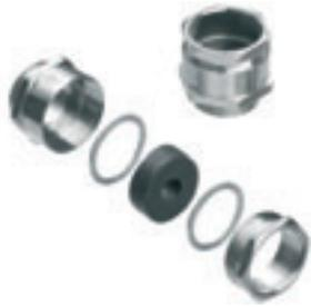
Латунный кабельный ввод с многослойными отделяемыми уплотнительными вставками для типового промышленного применения. Используемая уплотнительная вставка содержит несколько извлекаемых или отделяемых слоев. Это позволяет используя одну уплотнительную вставку осуществлять подключение кабелей различных диаметров варьирующихся в диапазоне от до мм.
