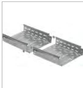
Лотки соединяются с помощью разъемов «мама-папа» и прочно фиксируются комплектом соединительным КС М6х10. Стандартная длина лотков – 3 метра.
