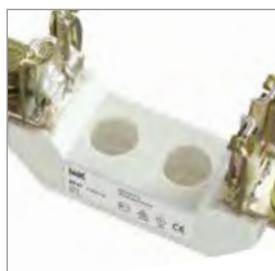
Основание держателя (изолятор) выполнено из армированной термореактивной пластмассы, стойкой к коррозии, механическим воздействиям, перепадам температуры и динамическим ударам, возникающим при коротких замыканиях,  $\leq 120$  кА.
