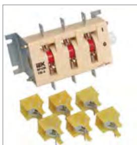
Дугогасительные камеры, большой раствор контактов, двойной разрыв цепи обеспечивают эффективное гашение электрической дуги при коммутации нагрузок, что снижает износ контактов.
