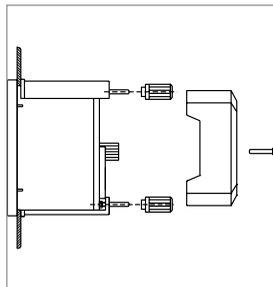
Монтажные элементы: гайки, винты крепления, пластиковые фиксаторы на панель щита, входящие в комплект поставки приборов, обеспечивают легкий монтаж без применения дополнительных элементов.
