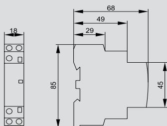
КМ25-40М AC/DC, КМ40-40М AC/DC, КМ63-40М AC/DC
