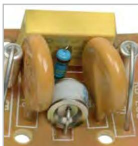
Два варистора обеспечивают защиту от импульсных перенапряжений.
