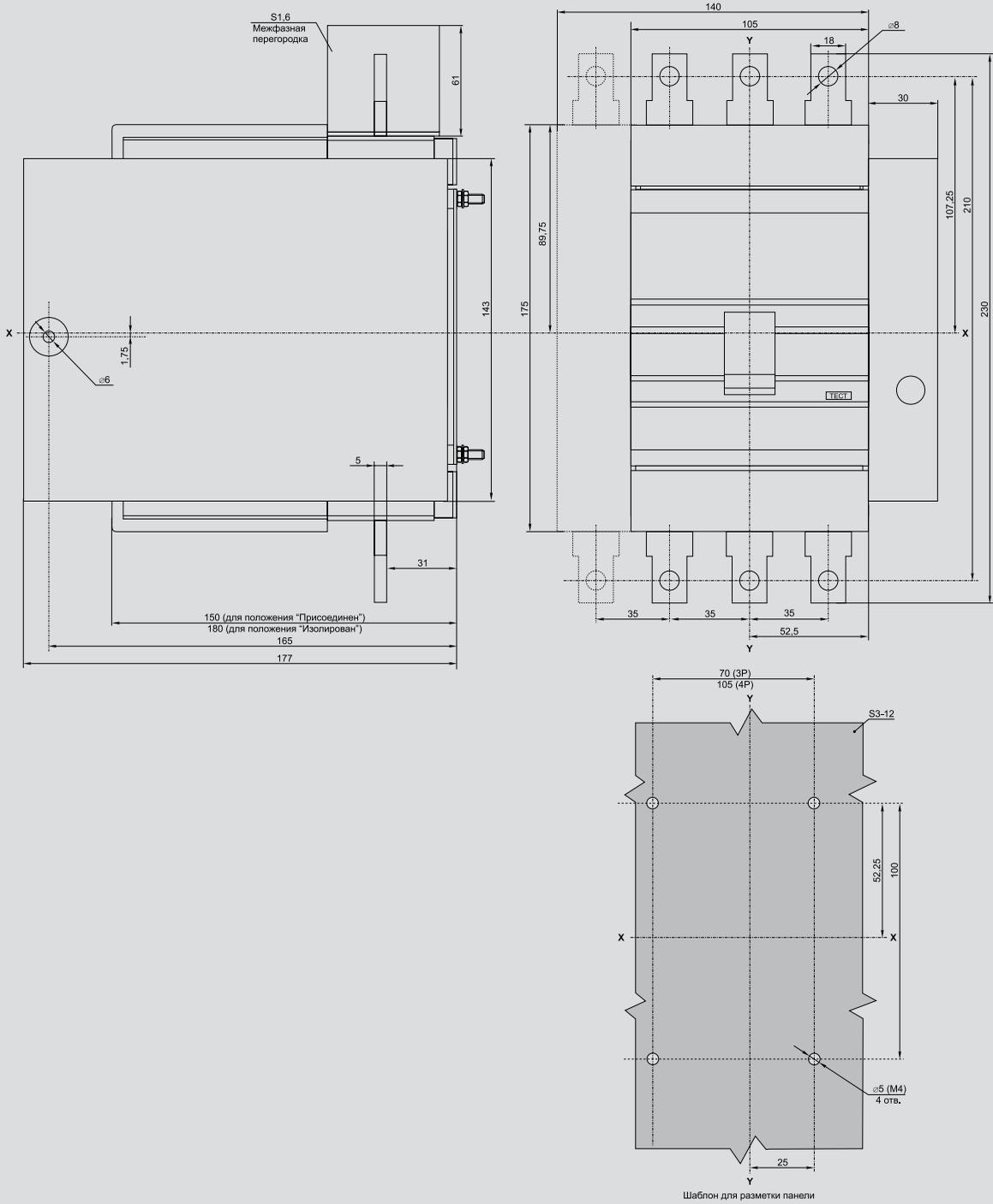
ВА88-35 с выдвижными панелями заднего резьбового присоединения ПМ2/Р-35
