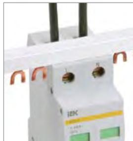
Реализована возможность двойного одновременного присоединения как шиной (PIN или FORK), так и гибким проводником сечением до 25 мм<sup>2</sup>.
