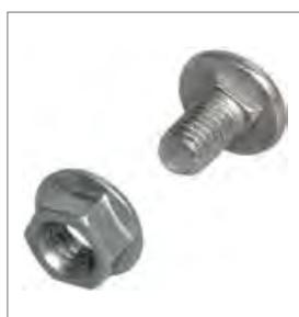
Для соединения кабельных лотков между собой и с аксессуарами используется универсальный соединительный комплект КС М6х10. Благодаря квадратному подголовнику, фиксирующему винт, для монтажа кабельной трассы потребуется только один ключ на 10 мм.
