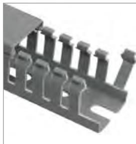
Все перфорированные кабель-каналы серии «ИМПАКТ» имеют специальную насечку у основания зубца. Благодаря этой риске ламель отламывается ровно, не оставляя зазубрин на основании канала. Это позволяет исключить повреждение изоляции провода при заведении его в канал.
