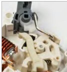
Механизм мгновенной коммутации. Повышает износостойкость при частых операциях. Скорость замыкания контактов не зависит от скорости движения рычага взвода.
