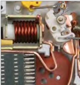
Механизм свободного расцепления новой конструкции, который обеспечивает быстрый разрыв главных контактов.
