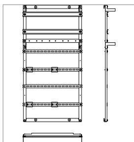
Съемная монтажная рама в корпусах ЩЭ-Х-1 и ЩЭ LIGHT. В ЩЭ-Х-1 можно устанавливать счетчики как на три точки крепления, так и на DIN-рейку. В ЩЭ LIGHT – на DIN-рейку.
