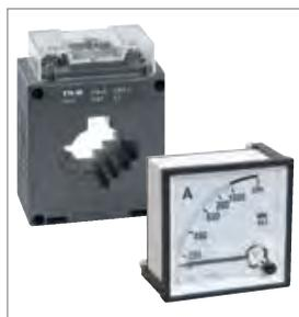
Амперметры, рассчитанные на измерение токов выше 50 А, подключают к измеряемой цепи через трансформатор тока с номинальным вторичным рабочим током 5 А.
