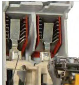
Дугогасительные камеры в каждом полюсе обеспечивают более эффективное подавление электрической дуги.
