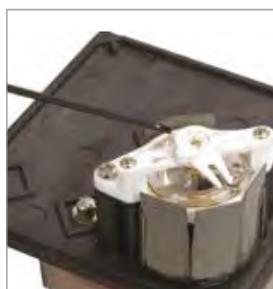
Металлический экран защищает электромагнитную систему от внешних магнитных полей.
