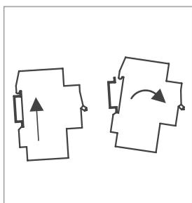
Удобный монтаж/демонтаж без использования инструментов (для конструктива 50 А и 63 А).
