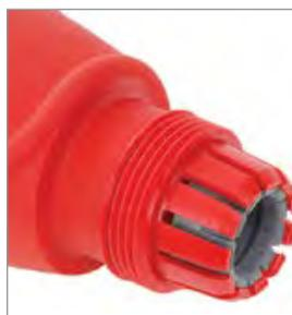
Цанговый зажим с сальником из эластичного материала, благодаря наличию зубцов на цангах, обеспечивает при затяжке гайки надежную фиксацию кабеля в корпусе, а также требуемую степень защиты IP.
