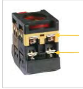
Подключение проводников производят винтовыми зажимами с тарельчатыми шайбами, которые обеспечивают надежную фиксацию проводов.
