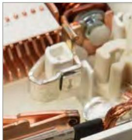
Увеличенная напайка из серебра с повышенной износостойкостью к воздействию токов короткого замыкания, обеспечивает низкое переходное сопротивление.
