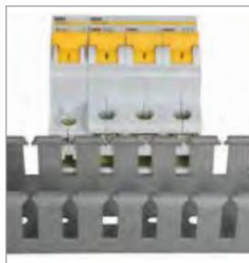
Шаг перфорации совпадает с шагом контактных зажимов на модульной аппаратуре, что исключает наложение клеммы на зубец канала. Благодаря этому время монтажа сокращается.
