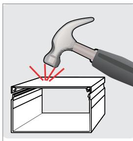
Специальные модификаторы ударпрочности придают кабель-каналу дополнительную прочность.
