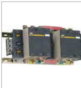
Собранный на заводе реверсивный контактор поставляется с заводскими шинами и механической блокировкой. Контактors смонтированы на двух металлических рейках, что обеспечивает высокую жесткость конструкции. Реверсивные контакторы КТИ представляют собой отдельную группу в ассортименте компании.
