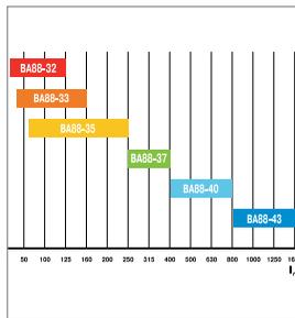
Полный диапазон тепловых расцепителей дает возможность обеспечить селективность при многоступенчатой системе защиты.
