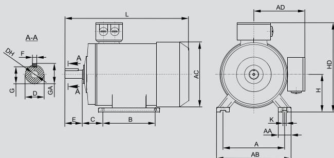
Размеры двигателей габаритов 56–160 монтажного исполнения IM 2081
