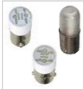
Съемные неоновая лампа и светодиодная матрица имеют различные цветовые исполнения. Матрица универсальна на напряжение 12, 24, 36, 110, 230 В как переменного, так и постоянного тока. Возможна замена неоновой лампы светодиодной матрицей.
