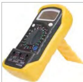
У мультиметров серий MASTER и PROFESSIONAL в комплект поставки входит прорезиненный чехол, защищающий прибор от повреждений при падении. Выдвижная ножка чехла позволяет удобно располагать мультиметр во время измерений.
