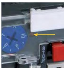
О текущем состоянии размыкающих и замыкающих контактов информирует индикатор на передней панели.
