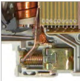
Защита от изменения заводских настроек механизма теплового расцепителя плексигласовой вставкой.
