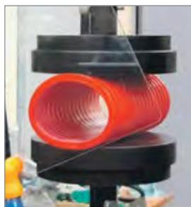
Особенность конструкции двустенных труб обеспечивает кольцевую жесткость, гибкость, ударную прочность.
