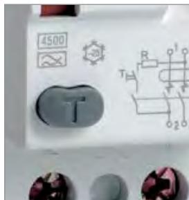
Эргономичная кнопка «ТЕСТ» для проверки работоспособности устройства и правильности подключения. Номинальный условный ток короткого замыкания 4500 А позволяет выдерживать более высокие сверхтоки, чем предыдущие серии дифференциальных выключателей.
