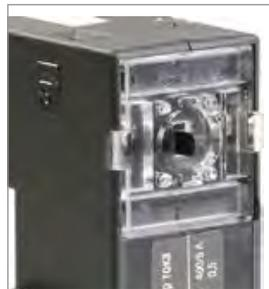
Клеммные зажимы вторичной обмотки закрываются прозрачной крышкой, что обеспечивает безопасность при эксплуатации. Крышку можно опломбировать. Это важно в схемах учета электроэнергии, т.к. исключает несанкционированный доступ к клеммным зажимам вторичной обмотки.
