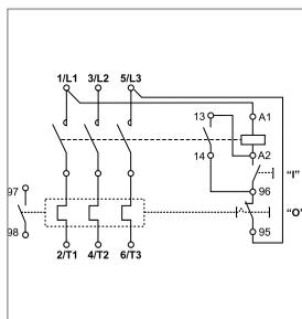
В качестве нагрузки в большинстве случаев выступают асинхронные трехфазные двигатели с напряжением 400 В. С целью снижения денежных затрат и экономии рабочего времени рекомендуется применять данную систему управления, так как исключается необходимость использования четвертого нулевого рабочего проводника, его разделки и монтажа.
