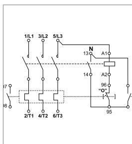
При управлении активными нагрузками (нагревательные цепи, цепи освещения), которые используют нулевой провод, рациональнее применять схему управления на 230 В.
