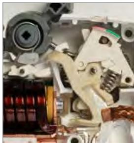
Механизм мгновенной коммутации увеличивает электрическую износостойкость.
