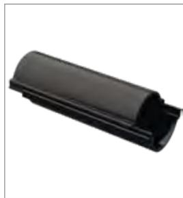
Трубы состоят из двух одинаковых частей. При монтаже кабель укладывается на нижнюю часть, затем верхняя часть защелкивается. При соединении труб верхняя часть перекрывает нижнюю примерно на 30 см.
