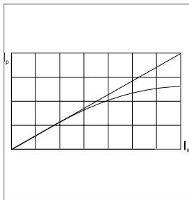
Токоограничение, т.е. фактический ток во время короткого замыкания, гораздо ниже расчетного за счет увеличенной скорости разрыва контактов, динамическое действие магнитного поля и структура дугогасящей камеры способствуют гашению дуги в самое кратчайшее время.
