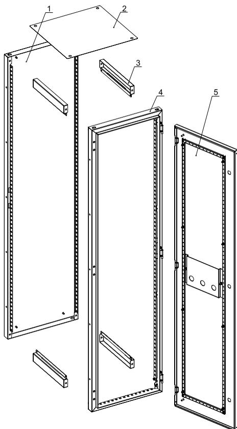
Суммарная высота, закрываемая панелями ЛГ/ЛМА, составляет величину, равную высоте корпуса за вычетом 100 мм.
