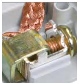
Насечки на контактных зажимах предотвращают перегрев и оплавление проводов за счет более плотного и большего по площади контакта. Это снижает переходное сопротивление контакта и, как следствие, потери. Увеличивается механическая устойчивость соединения.
