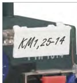
Наличие поверхности для нанесения маркировки позволяет делать указание на соответствие схеме, что упрощает монтаж.
