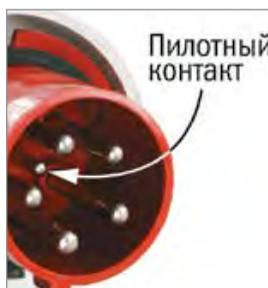
Разъемы на токи 63 и 125 А оснащены «пилотным» контактом, который включается после того, как другие контакты вилки соединены, а при отключении именно он размыкается первым.
