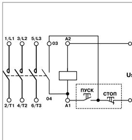
В схеме каждого контактора имеется одна группа замыкающих контактов, встроенных в модуль катушки управления. Это при наличии кнопочного поста управления позволяет собрать простую схему управления.
