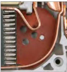
Дугоотводящая пластина подвижного контакта выполнена в виде гладкой кривой, что значительно облегчает затягивание дуги в дугогасительную камеру.
