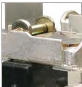
На контакт-детали нанесено серебряное покрытие, позволяющее использовать контакторы в продолжительном режиме работы. Напайки на контакт-детали выполнены из композитов на основе серебра, что позволяет уменьшить контактное сопротивление при повышении температуры.
