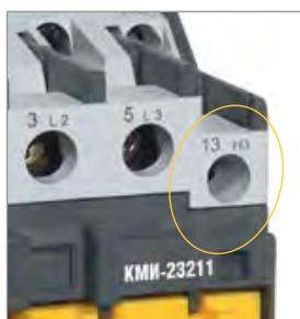
Наличие встроенных дополнительных контактов. Каждый контактор до 32 А комплектуется одним встроенным дополнительным контактом: 1з или 1р (замыкающий или размыкающий). Контакторы от 40 до 95 А комплектуются двумя дополнительными контактами: 1з + 1р.
