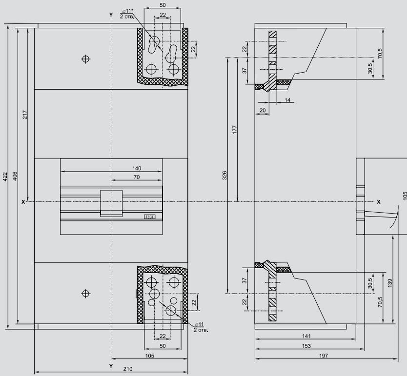
\*Отверстия предназначены для крепления наконечника-переходника
