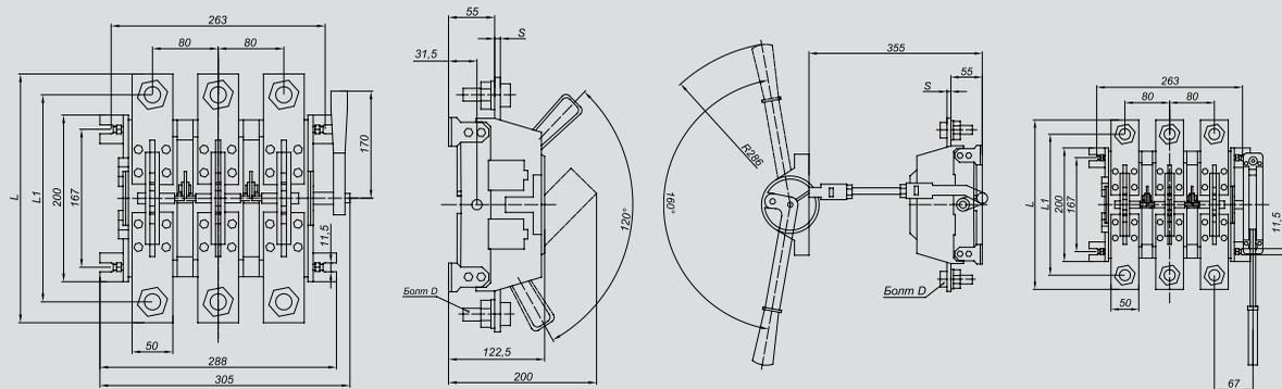
PE19-39-31160, PE19-41-31160 и PE19-43-31160 с рычагом для полюсного оперирования штангой
