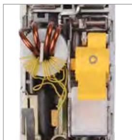
Не имеет собственного потребления электроэнергии и сохраняет работоспособность при обрыве нулевого проводника.
