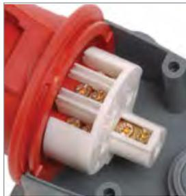
Зажимы столбчатого типа с двумя винтами направлены в одну сторону для удобства монтажа. Торцы винтов зашлифованы, что исключает перерезание жил.
