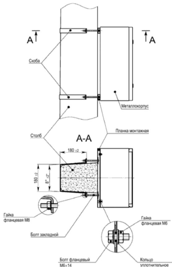
Схема крепления корпуса к столбу монтажной полосой
