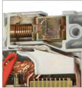
Напайка из серебросодержащего композита повышает износостойкость контактной группы и снижает переходное сопротивление.
