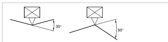
При монтаже проводов нейтрали на подвесах или зажимах не допускайте изгиба проводов на углы больше:
