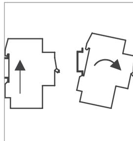
Удобный монтаж/демонтаж без использования инструментов.
