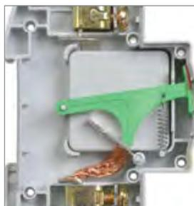
Повышена надежность работы благодаря снижению рассеиваемой мощности (на 15–20 %) вследствие исключения переходного сопротивления в разъемном соединении сменного модуля и корпуса изделия.
