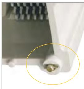
Верхняя крышка закреплена при помощи винтов с фиксацией. Это исключает самопроизвольное развинчивание. Поэтому контакторы серии КТИ можно устанавливать в места, где присутствует постоянная рабочая вибрация.
