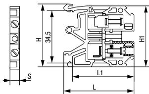
Применяются для крепления фазных, нулевых и защитных проводников. Устанавливаются на DIN-рейку.
