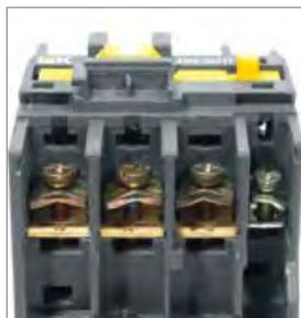
Присоединительные контакты овальной формы обеспечивают надежную фиксацию проводников: – для габаритов 1 и 2 – с закаленными тарельчатыми шайбами; – для габаритов 3 и 4 – с зажимной скобой, позволяющей подсоединить контакт большего сечения.
