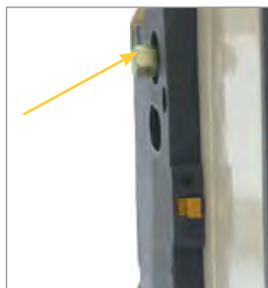
Использование стандартного торцевого ключа для изменения усилия прижатия контактной системы и проверки действия контактной системы.
