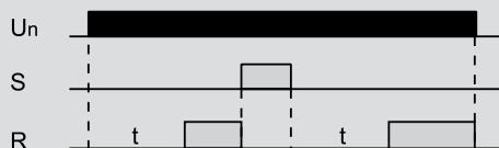
Диаграмма работы реле задержки включения ORT-A
