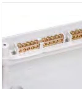
Съемный держатель шин N и PE можно устанавливать как вверх, так и вниз корпуса на специальные крепления. Сами же шины N и PE устанавливаются на съемный держатель простым защелкиванием в посадочные места.
