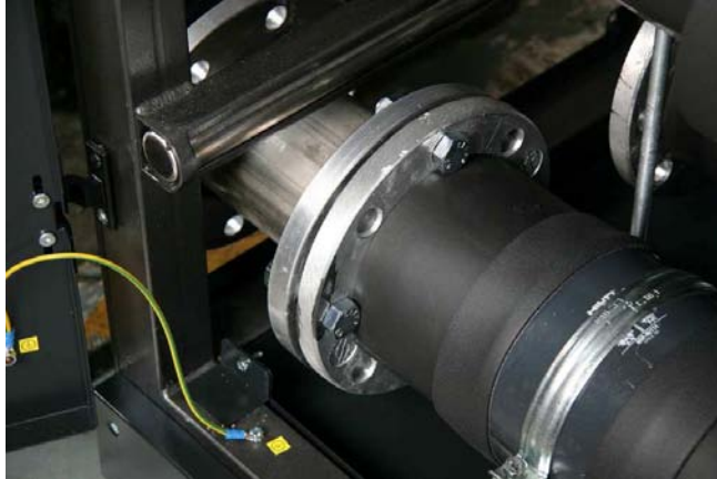
Abbildung: Flanschverbindung, hier Zwischenflansch für Anschluss einer weiteren CTU
