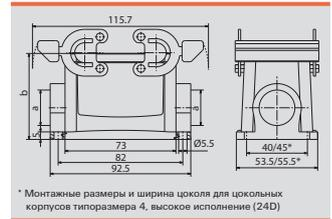
\* Монтажные размеры и ширина цоколя для цокольных корпусов типоразмера 4, высокое исполнение (24D)
