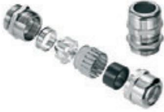
Латунные кабельные вводы для экранированного кабеля обеспечивает защиту от высокочастотных помех затухание до дБ Большая поверхность контакта с экраном кабеля обеспечивается благодаря металлическому каркасу конической формы
