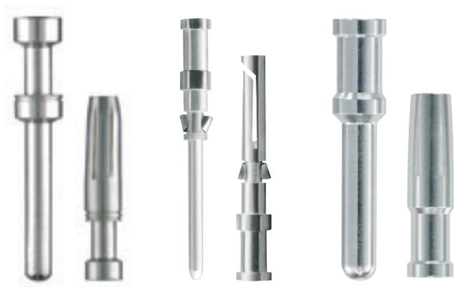
Контакты это главная часть разъема Они создают соединение между двумя проводниками Для этого необходимы два типа контактов штекеры и гнезда Штекер проводит электрический ток по своей наружной поверхности и вводится в гнездо в котором ток проводится по внутренней поверхности Промышленные соединительные разъемы имеют контакты из медного сплава а контактные поверхности покрыты золотом или серебром серебро улучшает электропроводность золото обладает стойкостью к коррозии
