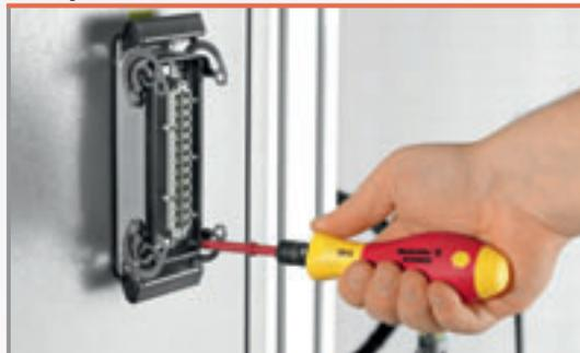
Динамометрические отвертки обеспечивают оптимальное крепление корпуса без снижения степени защиты IP.
