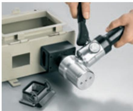
**Автоматическое кернение в местах сверления при пробивке отверстий для промышленных разъемов.**
