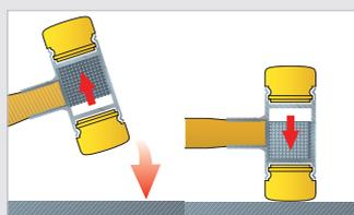
Специальное металлическое наполнение в головке молотка обеспечивает работу без отдачи.
