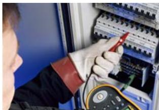
Тонкий щуп с кнопкой тестирования. Позволяет смотреть на панель во время измерения в труднодоступных местах. Данный щуп с дистанционным управлением питается от тестера и поэтому всегда готов к работе (не требует дополнительных батарей).
