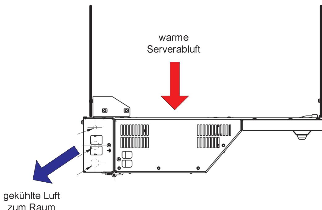
Die warme Serverabluft wird mittels Wärmetauscher auf ca. 22°C gekühlt, bevor diese dem Aufstellungsraum wieder zugeführt wird.
