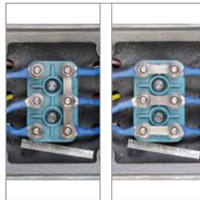
В зависимости от напряжения питающей сети перемычки на клеммной панели могут быть установлены:
