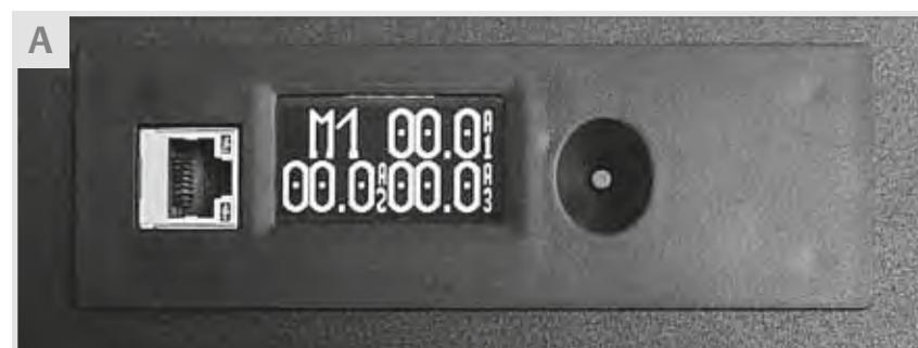
Das Gedrückthalten der Taste während des Einschaltens des Strommess-Moduls baut eine temporäre Verbindung zum DHCP-Netzwerk auf. Der DHCP-Server weist dem Strommess-Modul eine IP-Adresse zu und stellt die Verbindung zum Netzwerk her. Bei einem Zurücksetzen des Strommess-Moduls oder einer Unterbrechung der Stromversorgung verliert das Strommess-Modul diese temporäre DHCP-Einstellung.
