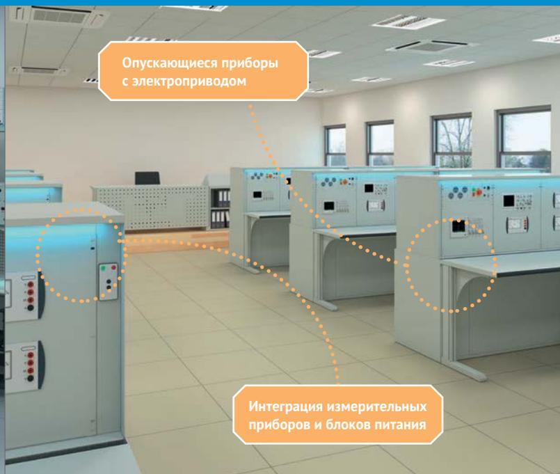
Опускающиеся приборы с электроприводом
