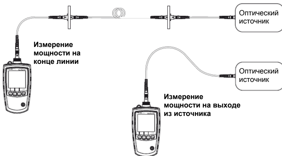
Подключения для измерения оптической мощности
