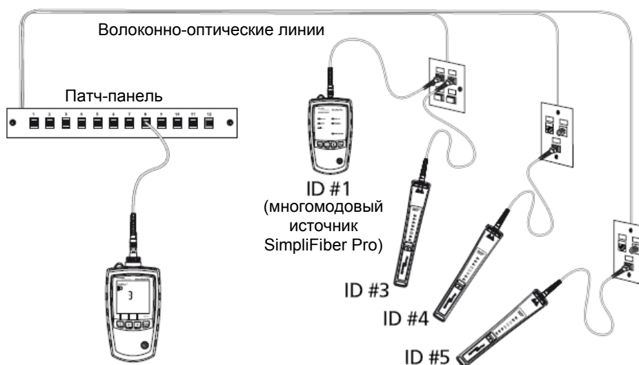
Использование режима FindFiber для поиска волокон
