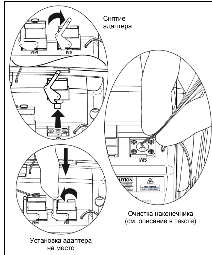
Рисунок 13. Очистка портов рефлектометра OTDR
