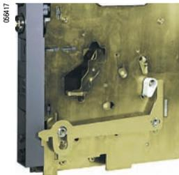
Блокировка дверцы при вкваченном аппарате
