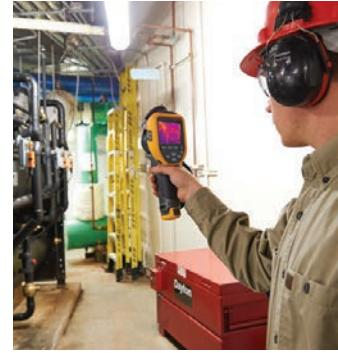
Поиск неисправностей на передовой с разрешением 320 x 240
