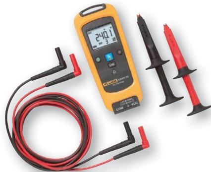
Fluke v3001 FC Модуль измерения напряжения переменного тока
