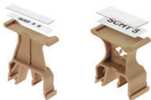
Групповой держатель шильдиков SCHT 5 / SCHT 5 S защелкивается непосредственно на DIN-рейке TS 32 (G-рейка) или TS 35 (рейка top-hat). Для идентификации клеммы на держателе устанавливаются шильдики MultiCard ELS, идентификация не зависит от клеммы и ее типа.
