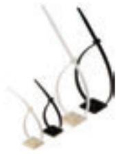
Кабельные стяжки СВ предназначены для закрепления кабелей и маркеров в случае особых требований. Они подходят для закрепления кабельных маркеров CLI M, SFX, WKM и WKS. Стяжки изготовлены из неразрушающегося полиамида PA 6.6 с классом пожаробезопасности V2 по UL94.
