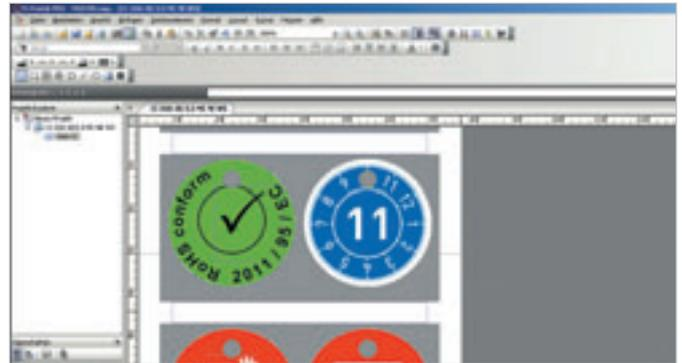
Благодаря возможности редактирования печати по кругу, можно подготовить для печати маркировки гидравлических шлангов, светильников в соответствии со стандартом DIN V VDE V 0108.100, кулачковых переключателей или этикеток с круговыми шкалами.
