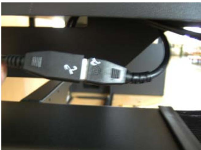
Кабели от управляющего контроллера соединяются с подъемными колоннами.
