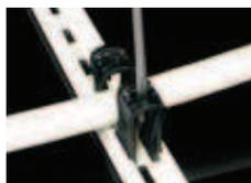
Скобы простые предназначены для крепления кабелей Ø от 10 мм до 26 мм на опорную рейку 5820 и 5822. Монтаж производится сгибанием скобы в виде U и установкой её в опорную рейку. Для предотвращения смещения закрепляется клином, который предварительно отпрессован на зажиме.
