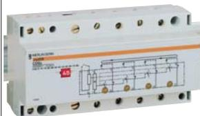
Отключает и повторно включает одну за другой 5 - 4 неприоритетных цепи, при этом каждые 5 минут изменяет порядок отключения цепей (циклическое отключение); имеет вход принудительного отключения.
