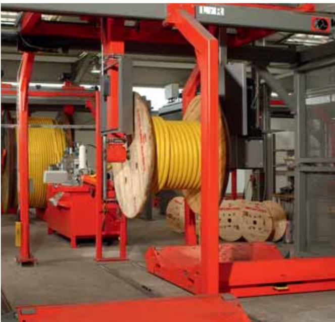
Отрезка с крупногабаритных барабанов
