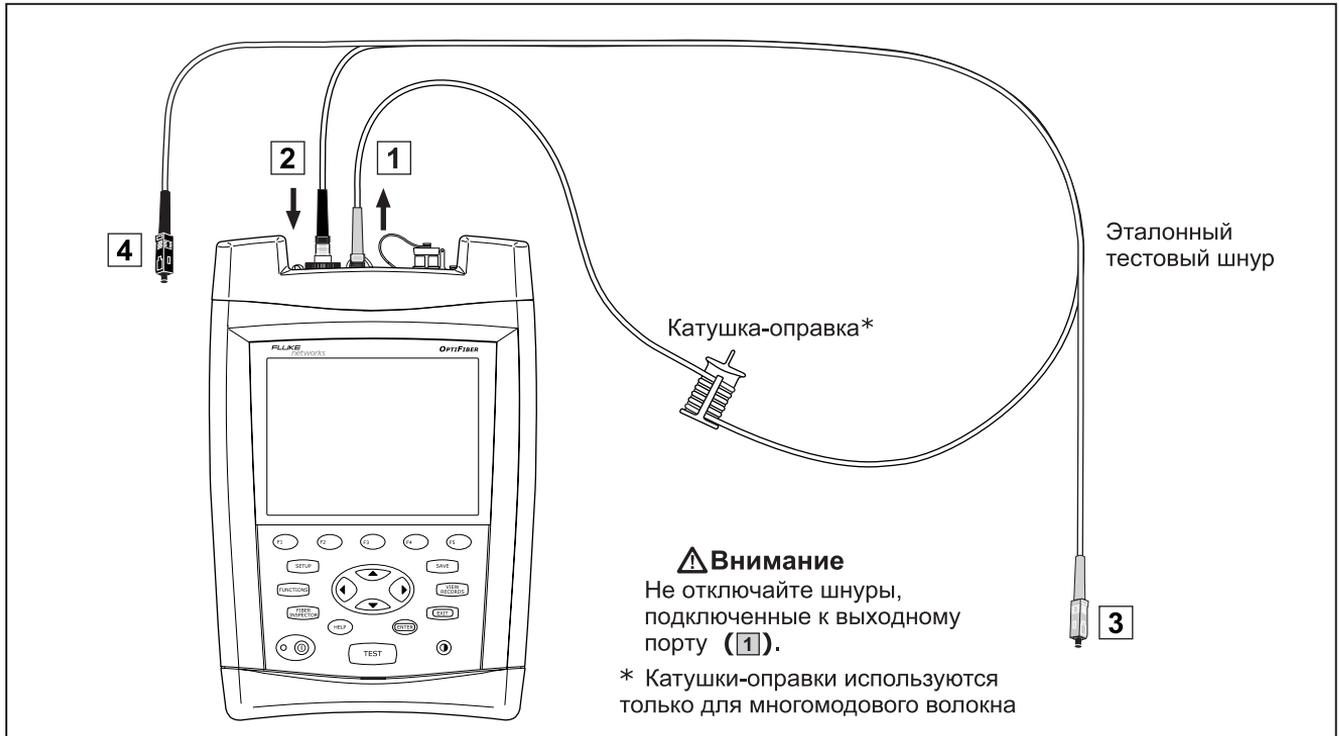
Рисунок 28. Подключения эталонных шнуров в режиме петли (Loopback)
