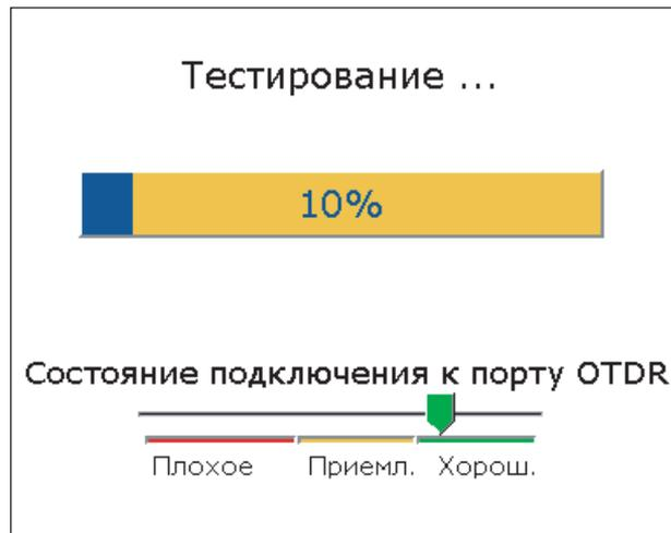
Рисунок 7. Отображение состояния коннектора OTDR
