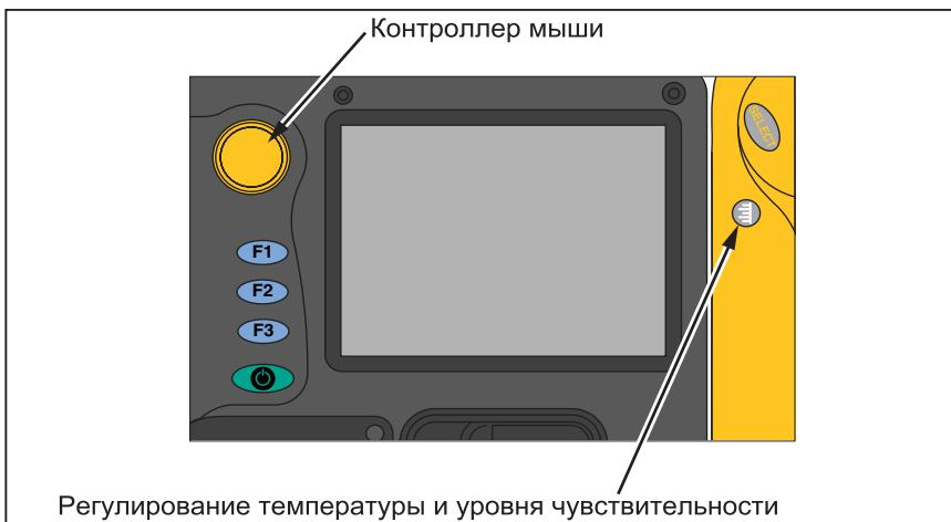
**Рисунок 1-7. Настройка уровня объединения IR-Fusion®**
