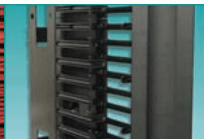
*Лицевые вертикальные органайзеры предоставляют от 232 до 464 кв. см. полезной площади поперечного сечения. Это позволяет удовлетворить потребности объектов с максимальной наполненностью оборудованием. Тыльный канал обеспечивает такую же емкость, но имеет открытую конструкцию, чтобы кабели было удобнее подводить к точкам заделки.*
