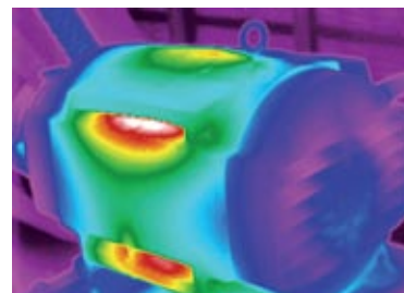
Аномальный неравномерный нагрев двигателя
