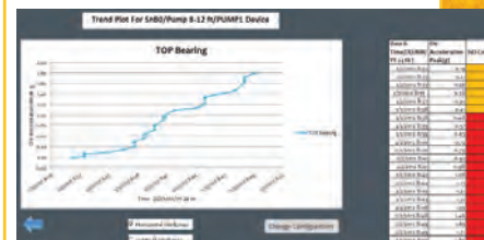
Пример графика тренда, построенного при помощи шаблона Fluke 805 для создания графика тренда.
